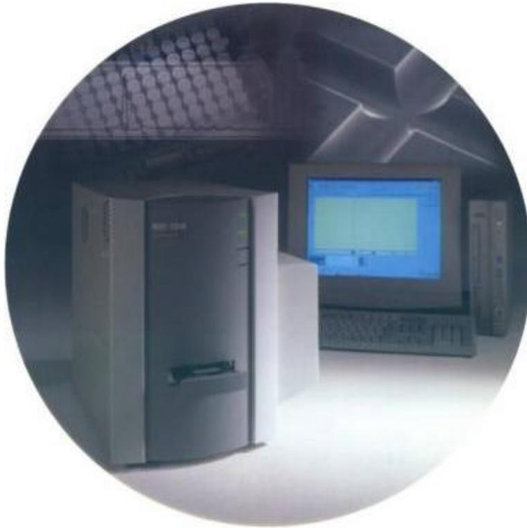
只需将样品的 DNA 溶液在仪器内，之后就可以自动获得与琼脂糖凝胶电泳同样的凝胶图象和分析结果，输送液体凝胶 → 样品上样 → 电泳 → 数据分析这一系列过程完全自动进行，没有人为错误，可以彻夜工作。
