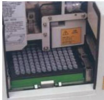
在输液、上样、电泳、测定数据到清洗微通道的一系列分析过程实现全自动化。上样、电泳及流体的控制完全电压操作控制。而且样品从微芯片自动上样。
