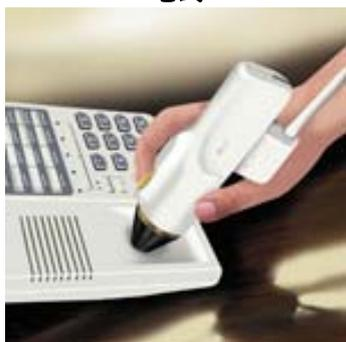
采用可移动的光学传感器，对凹形和受限制的样品进行优化测量
