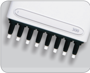
安全圆锥过滤器保护移液器免受污染。
